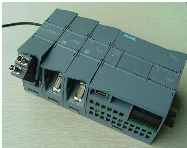
B、先在设备的 PROFIBUS/MPI/PPI 标准 DB9F 插座上插入一只带编程口的总线连接器以便于用电缆去连接其他站点，再在其上面插入光纤型 PROFIBUS 总线连接器。这时电缆的总线连接器须按 PROFIBUS 规范设置终端电阻开关。
