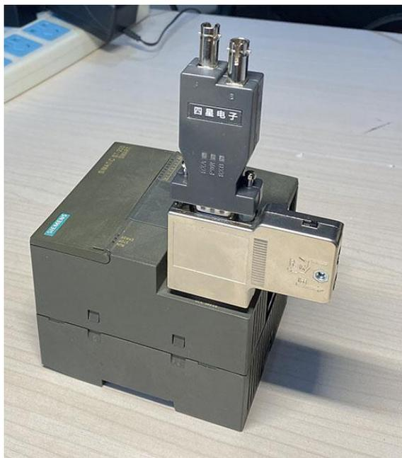
B、对于像 CP5611、CP5621、CP5613 之类的 PROFIBUS 板卡，也可直接将光纤型 PROFIBUS 总线连接器插到板卡的 DP 插座上，使之成为采用光纤传输的 PROFIBUS 通讯板卡。
